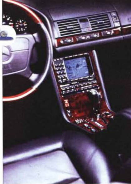
Figure 13 e 14 - Nella prima figura vediamo il cruscotto della Mercedes 500 in vendita in Giappone, dotata del sistema ITGS di serie. Nella seconda figura una schematizzazione delle quattro componenti fondamentali per un sistema di instradamento automatico intelligente: il giroscopio sostituisce momentaneamente il GPS quando il segnale del satellite è oscurato dalla presenza di vegetazione folta, di edifici alti o perché in galleria.
